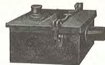
Fig. 55. Eksempel på fedtsamler af støbejern. En fedtsamler af den angivne type er beregnet til anbringelse under køkkenvaske, den skal ventileres over taget. Der kan kun forventes udskilt ret små fedtmængder.
